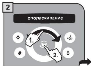
**3** Выбор производится с помощью поворота колесика. Вы можете установить:
