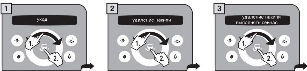
Удаление накипи производится при определенной температуре. Необходимо дождаться температуры, при которой производится очистка от накипи. Нагрев бойлера кофеварка произведет автоматически.
