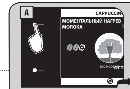
При нажатии на кнопку "МОМЕНТАЛЬНЫЙ НАГРЕВ МОЛОКА" функция ЭНЕРГОСБЕРЕГАЮЩЕГО РЕЖИМА дезактивируется и приводится в положение "OFF". (см. стр. 28).
