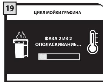
Начнется цикл ополаскивания. Отметка позволит визуализировать состояние прохождения цикла. По окончании цикла машина приводится на страницу для подачи продуктов.
