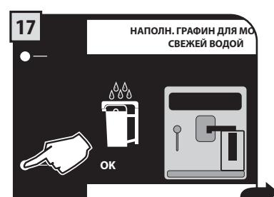
Удалить график, ополоснуть его свежей питьевой водой. Подтвердить нажатием на кнопку "OK".
