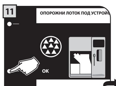
Освободить лоток каплесборник, находящийся под блоком (стр. 40 - рис.2) и вставить его на место. Затем нажать на "OK".
