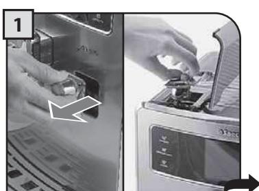
Снять защитную пробку машины и поместить для хранения в чистом месте. Рекомендуется вставить ее в гнездо крышки воды.
