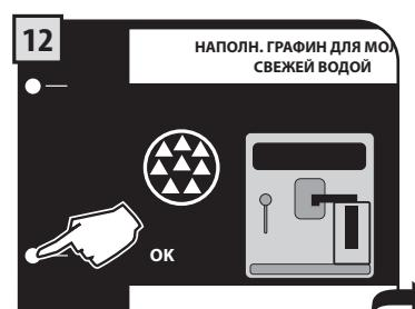
Опустошить полностью графин (стр. 38 - рис.7) и наполнить его свежей водой. Вставить графин и расположить его для подачи. Затем нажать на "OK".
