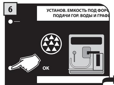
Расположить емкость под устройством подачи и емкость под трубкой горячей воды. Затем нажать на "OK".
