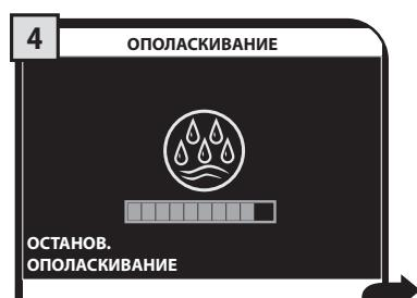
По окончании подогрева машина выполнит цикл ополаскивания внутренних контуров. Цикл можно прервать, нажав на кнопку "Останов. ОПОЛАСКИВАНИЕ".
