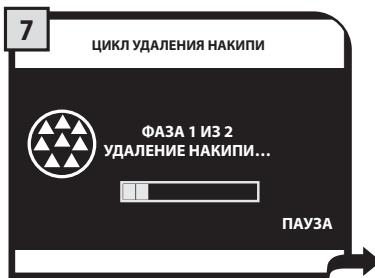
Начнется цикл удаления накипи. Отметка позволит визуализировать состояние прохождения цикла.
