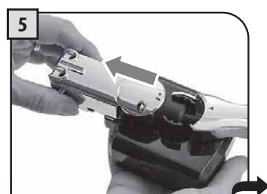
Вынуть соединитель, соединяемый с машиной.
