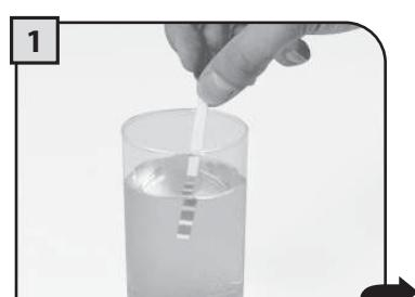
На 1 секунду погрузить в воду пробный образец для тестов жесткости воды, имеющихся в машине.
