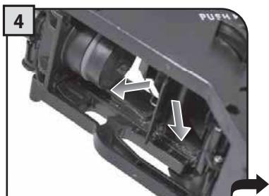
Распределить консистентную смазку равномерно по двум боковым направляющим.
