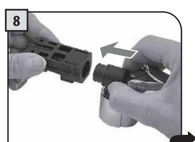
Снять треугольный внешний штуцер.
