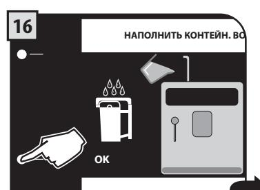
По окончании промывки наполнить бак свежей питьевой водой. Подтвердить нажатием на кнопку "OK".
