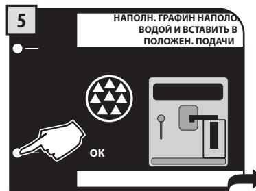
Наполнить до половины графин свежей водой (стр. 38 - стр.7). Вставить графин и расположить его для подачи. Затем нажать на "OK".
